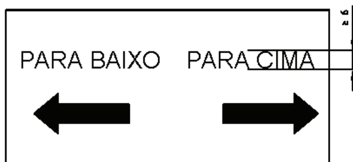
Figura 3 — Exemplo de uma etiqueta de sentido típica (volante manual)
